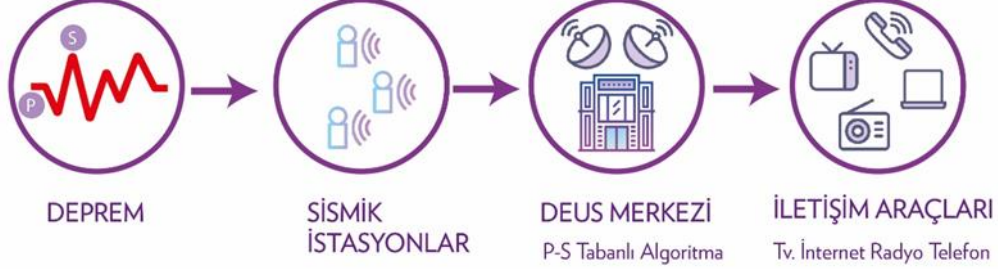
Şekil 1. İleri Deprem Uyarı Sisteminin Teknik Bileşenleri
